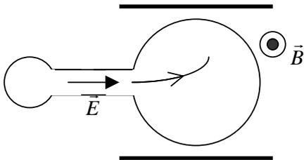
On observe une déviation du faisceau d'électrons lorsqu'il arrive avec une vitesse  $\vec{v}$  dans le champ  $\vec{B}$ . Par ailleurs:
