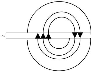
A chaque fois qu'une particule passe par la zone intermédiaire entre les deux D, elle doit être accélérée. Par conséquent, à la fréquence sinusoidale de fréquence  $\nu$ , doit changer de sens à chaque demi révolution, ce que l'on traduit par:
