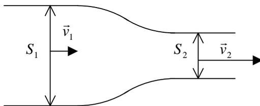
Pour un écoulement stationnaire homogène incompressible, la conservation du débit impose :  $S_1 v_1 = S_2 v_2$ , et la relation de Bernoulli le long d'une ligne de courant impose  $\frac{P_1}{\rho} + \frac{v_1^2}{2} = \frac{P_2}{\rho} + \frac{v_2^2}{2}$ .
