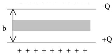
Le champ électrique dans le métal n'a pas changé, ainsi que le champ à l'extérieur toujours calculable par le théorème de Gauss. On a donc  $V_+ - V_- = \frac{Q}{A\epsilon_0} (b - e)$ , ce qui donne une nouvelle capacité  $C' = \frac{\epsilon_0 A}{(b - e)}$ .
