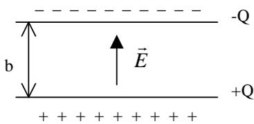
Le calcul de  $\vec{E}$  se fait par le théorème de Gauss et on obtient que  $\vec{E} = \frac{Q}{A\epsilon_0} \vec{u}_x$  et que la différence de potentiel vaut  $V_+ - V_- = \int \vec{E} \cdot d\vec{l} = \frac{Q}{A\epsilon_0} b$ . On en déduit la capacité du condensateur plan  $C = \frac{\epsilon_0 A}{b}$
