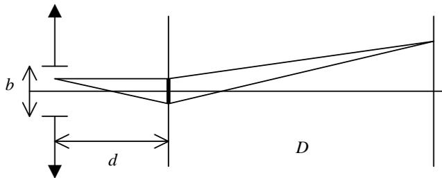
Isolons un élément de la source de largeur  $dX$  d'intensité correspondante  $dI = \frac{I_0}{b} dX$ . Par analogie avec le résultat obtenu pour les trous d'Young, la différence de marche introduite par la fait que cette source
