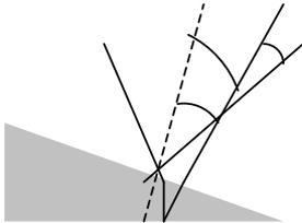
On voit alors que les franges sont localisées au voisinage du coin d'air, et plus précisément sur un plan au voisinage de la lame.
