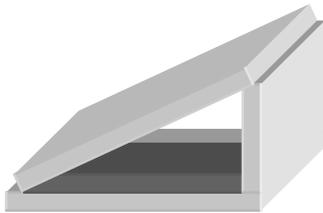
Le coin d'air ainsi constitué est observé par réflexion . On voit alors deux systèmes de franges rectilignes identiques, décalés du fait de la présence de la lame à mesurer. Le décalage se trouve en disant que la phase doit être la même lorsque l'on passe d'une frange sombre à une autre, soit  $X_1\alpha = X_2\alpha + t$  . On en tire  $t = (X_1 - X_2)\alpha$  . Si on ne connaît pas  $\alpha$  , on peut utiliser
